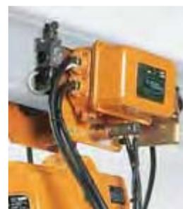
**Freno motore del tipo con rotore cilindrico ad attrazione**
