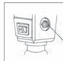
Nei modelli con comando a cilindro la vite di regolazione è posizionata a lato del comando per il cambio di velocità.
